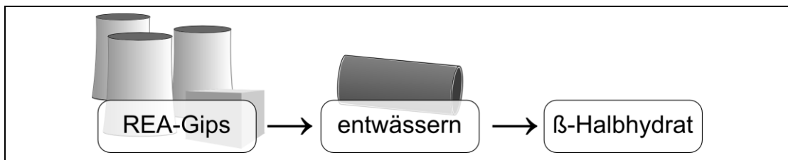
Abbildung 2: Produktion Stuckgips ( \beta -Halbhydrat) aus REA-Gips
